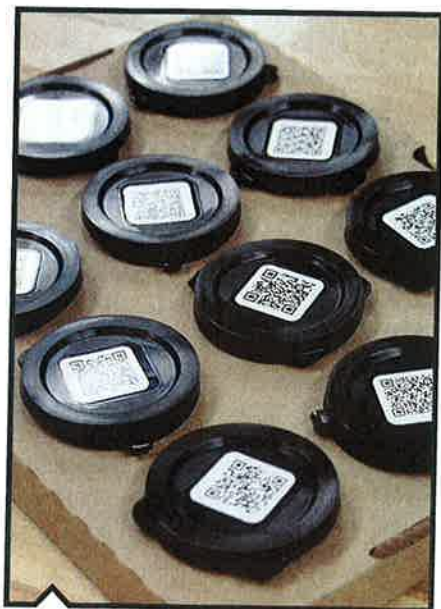
Les cupules de terre de Logiag possèdent un code QR. De cette façon, la cupule est associée à sa position dans le champ dès le moment de l'échantillonnage.
