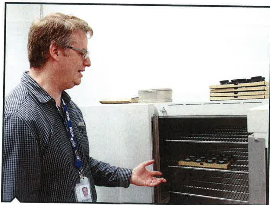
Lorsque les échantillons de sol arrivent au laboratoire, ils sont placés dans une étuve pendant plusieurs heures pour que la terre sèche.
