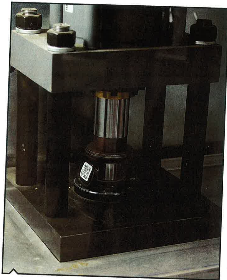
La terre est ensuite pressée afin que sa surface soit uniforme avant d'être analysée par le laser.
